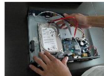
Подключите к жесткому диску кабель данных и питания (те же действия повторите для установки остальных жестких дисков для моделей, поддерживающих более одного диска).
