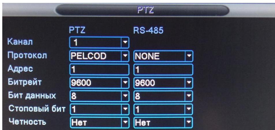
В данном подразделе пользователь настраивает подключение скоростной поворотной камеры. Для корректного подключения выберите подходящий протокол, адрес, битрейт (качество записи), бит данных, стоповый бит, четность.
